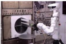
宇宙飛行士の作業を代替する G I T A I のアバターロボット Source: Gitai Inc.
