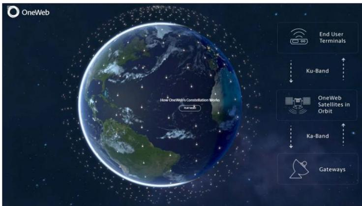
OneWeb が構想していた衛星通信のサービス概要図 Credit : OneWeb
