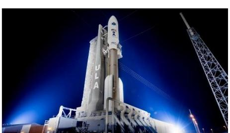
打ち上げロケットは、ULA (ユナイテッド・ローンチ・アライアンス) のアトラス V。直径 5m のペイロードフェアリング、固体ロケットブースター (SRB) を 5 つ使用した「551」と呼ばれる仕様 (静止トランスファ軌道打ち上げ能力 8.9 トン) です。
