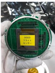
軟 X 線観測用の裏面照射型 CMOS 検出器。
